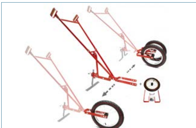
Bild 1. Med ett enkelt handgrepp byggs enhjulshackan om till tvåhjulshacka – eller tvärt om.
